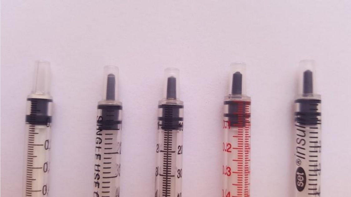
En solda BD'ye ait insülin enjektöründe ölü boşluk diğer enjektörlere göre çok fazla olduğu için 0,05 ml'lik enjeksiyon dozunun %64,5 enjektörde kalmaktadır.
